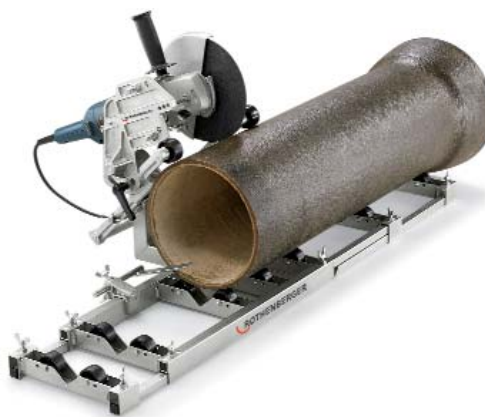
Рисунок: ТРЕННБОЙ 300 с двойной телескопической удлинительной рейкой правой (№ 5.8527). (углошлифовальная машинка в комплект не входит) и левой (№ 5.8528), ограничитель вращения и длины (№ 5.8529).
